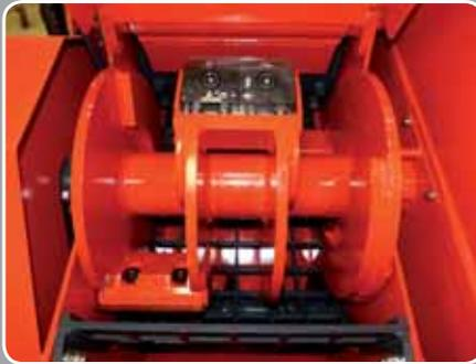
*Hackrotor Durchmesser 600 mm mit 6 Hackmessern und großer Schwungmasse*
